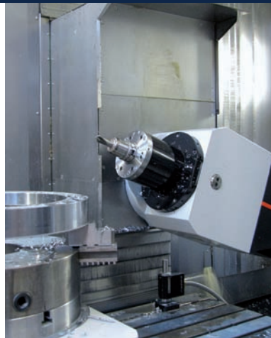
Dankzij de rotatie van de B-as over een hoek van -110° tot +110° kan een werkstuk ook aan de onderzijde worden bewerkt. De extra hoogte die door de C-unit wordt gecreëerd, biedt daarvoor alle ruimte (foto: Jan Oonk)
