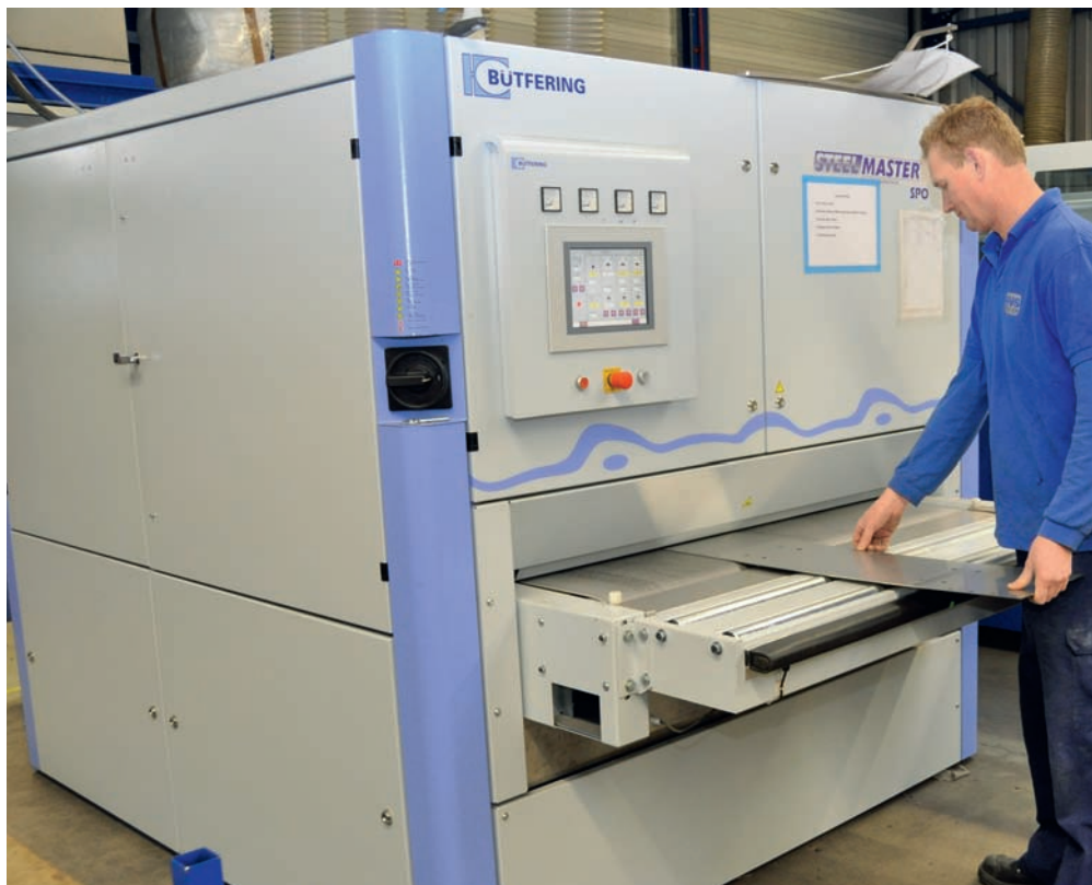
Er is een aparte hoek ingericht voor het borstelen, ontbramen en polijsten van roestvast stalen producten (foto: RVS Finish)
