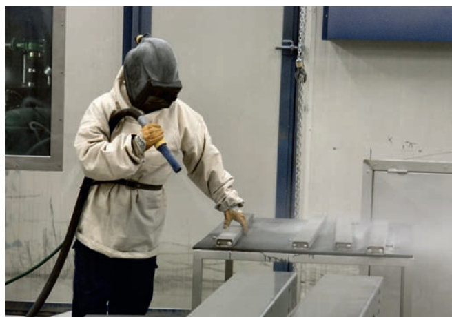
Het keramisch stralen wordt veel gebruikt voor producten waarbij een egale gladde afwerking vooral een cosmetische waarde heeft (foto: Paul Quaadvlieg)
