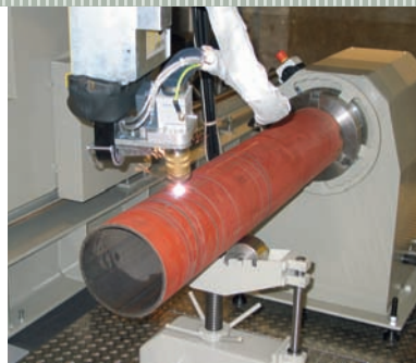
Plasmasnijden kan prima toegepast worden voor het snijden van hoogwaardige buizenmaterialen
