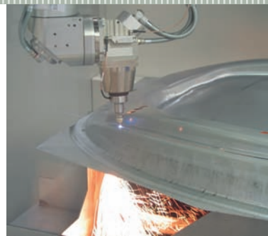
Het lasersnijden wordt veel toegepast bij materiaaldiktes van 2 mm tot 8 mm
