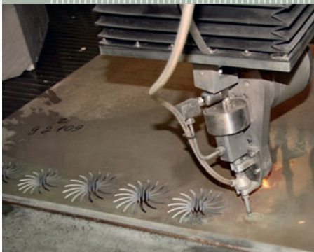
Naast het snijden van constructiematerialen is abrasief waterstraalsnijden uitermate geschikt voor harde en slijtvaste metaallegeringen
