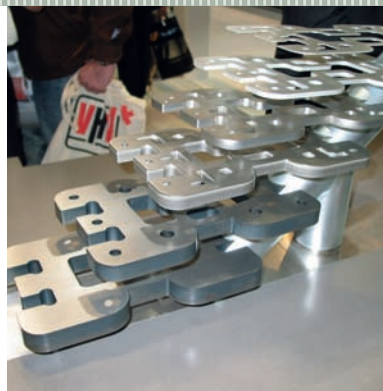
Hoe krachtiger de laser, des te dikker materiaal kan ermee gesneden worden
