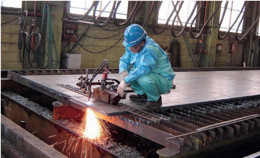
Eenvoudige mechanisatie met behulp van een geleidingsstrip bij het autogeen snijden (foto: Theo Luijendijk)
