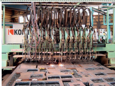
Bij het autogeen snijden kunnen een groot aantal toetsen gelijktijdig gebruikt worden (foto: Theo Luijendijk)
