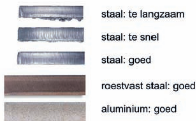
Figuur 2: invloed van de snijnelheid op de kwaliteit van de snede bij het plasmasnijden (bron: Joep Buitink)
