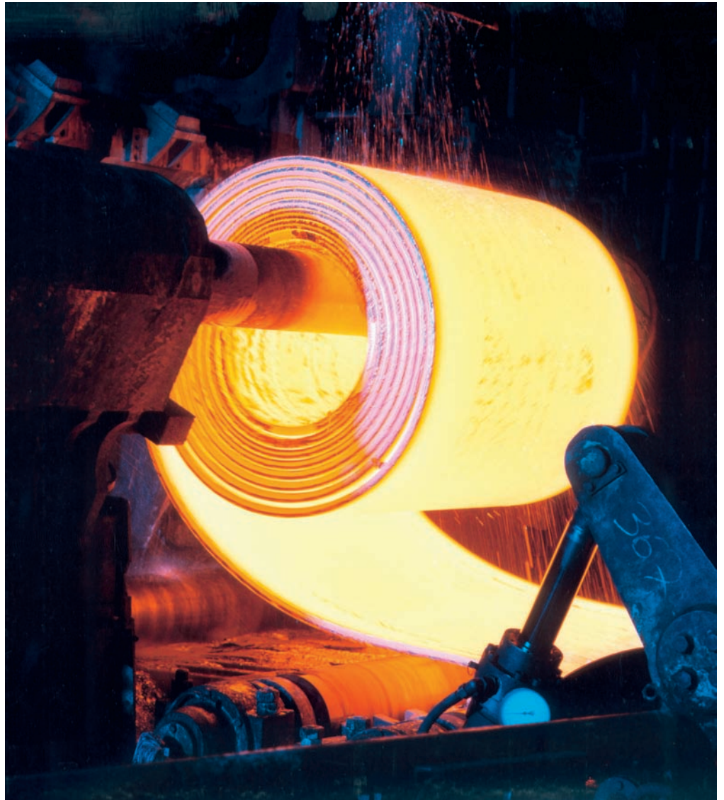
Om ongewenste afkoelingen, en dus ongewenste materiaalveranderingen, te voorkomen wordt in deze zogeheten 'Coilbox' van ThyssenKrupp in Bochum (D) warmgewalst band opgehaspeld. Voor veel materiaaleigenschappen is (warm)walsen een essentiële bewerkingssap (foto: ThyssenKrupp Steel AG)
