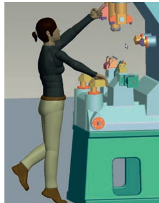
Met Pro/Engineer Manikin Extension kan interactief het productontwerp getest worden. Een draaiboek van de handelingen die de Manikin doet ten opzichte van het product wordt gecreëerd (foto: Holland Engineering Consultants)
