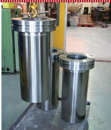
Deze hydraulische componenten zijn na het coatingbad licht gepolijst en zijn klaar voor verzending naar de klant (foto: Paul Quaedvlieg)
