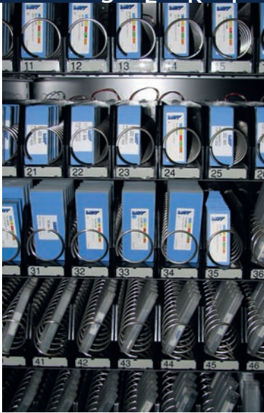
De gereedschappen keurig geordend in de Tool-O-Mat-kast. Aard en aantallen worden afgestemd met de klant, waarna WNT het beheer van de voorraad voor zijn rekening neemt (foto: Jan Oonk)
