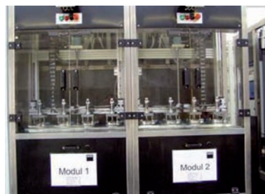
Het verchromen in de machine duurt circa twee minuten (foto: Cookson Electronics Enthone)
