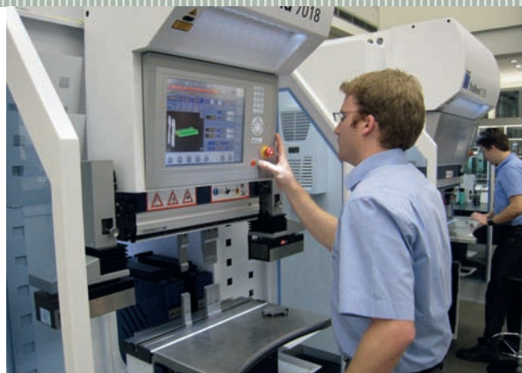
Ook Trumpf begeeft zich met de TruBend 7018 en 7036 op het pad van de elektrisch aangedreven afkantpersen, echter met direct-drivemotoren met spindels (foto: Reinold Tomberg)
