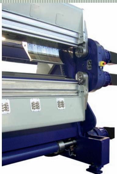
Bij de Multifold E-drive-buigautomaat van Darley worden de boven- en onderbalk aangedreven door AC-servomotoren (foto: Darley)
