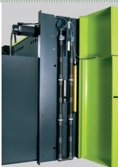
Safan bouwt nu de derde generatie E-Brakes. De servomotoren (bovenin) bevinden zich nu links en rechts van het frame (foto: Safan)
