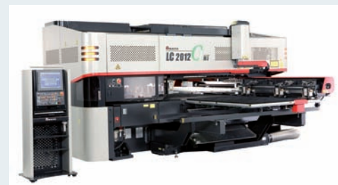
Het servo-elektrische ponsgedeelte van de machine heeft een maximale ponskracht van 200 kN (20 ton) en kan materiaal met een maximale dikte van 6 mm bewerken (foto: Amada)
