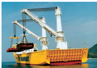
Fig.2 Geringer gewicht van de kranen leidt tot een grotere laadcapaciteit van het schip (foto: Huisman)
