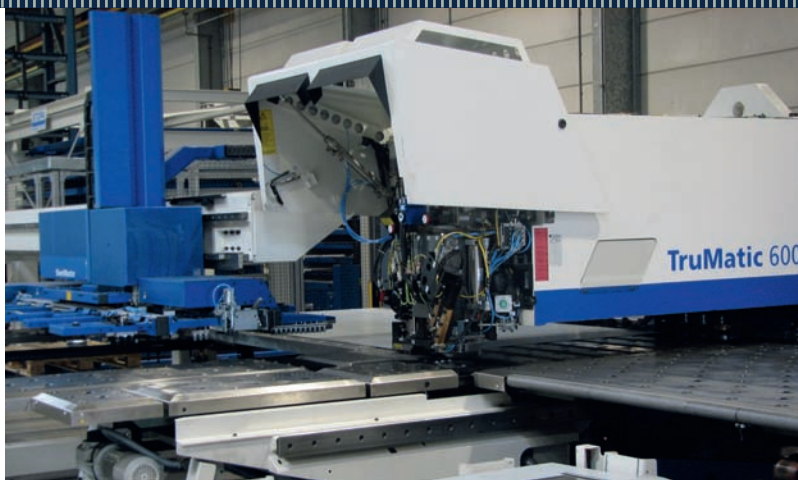
De Trumatic 6000-ponslasercombinatie is via een SheetMaster gekoppeld is aan een Stopa-magazijn met 20 plaatsen en een totale capaciteit van 60 ton
