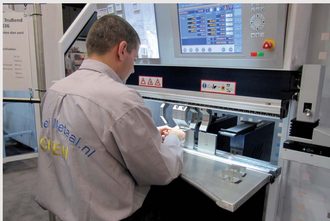
De TruBend 7036 van Verheij in actie op de stand van Trumpf tijdens de Techni-Show 2010. Het is een relatief kleine afkantpers die helemaal ontworpen is voor het zittend plaatbuigen (foto: Reinold Tomberg)
