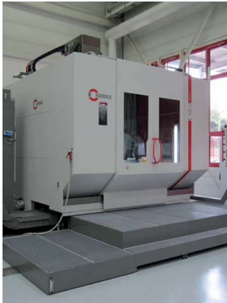
De C 60 zoals voorgesteld in Gosheim (D). Over de lineaire assen kan deze machine een ijsnelheid van 50 m/min bereiken. Een gebruiker kan kiezen uit verschillende spullen met maximale toerentallen van 9000 min -1 , 10000 min -1 , 12000 min -1 en 18000 min -1
