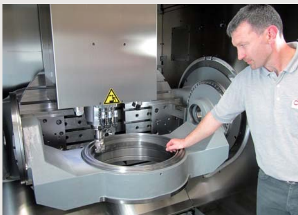
De C 60 van Hermle met als opgespannen werkstuk een draaizwenktafel van een kleinere C-machine. De A-as kan zwenken over \pm 130 graden (260 graden totaal). Het maximale toerental voor de A-as is 15 \text{ min}^{-1} en voor de C-as 30 \text{ min}^{-1} (foto's: Reinold Tomberg)
