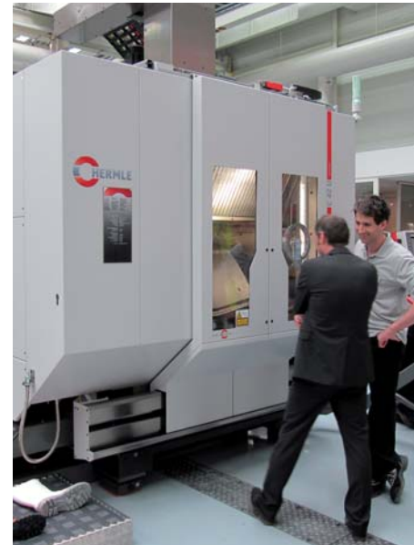
De nieuwe vijfassige C 42 U dynamic. Hermle kan deze machine leveren met een Heidenhain iTNC 530 HSCI CNC-besturing of een Siemens 840D SL. 95% van de besturingen die Hermle levert, is van het fabrikaat Heidenhain
