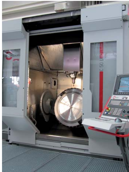
De C 50 U MT dynamic van Hermle. Bijzonder is dat de draaibewerkingen uitgevoerd kunnen worden in elke stand van de draaizwenktafel. Bij lichte verspaning kan zelfs de A-as simultaan bestuurd worden, bijvoorbeeld voor het maken van achtersnijdingen
