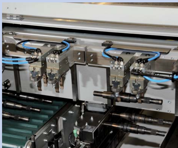
De Smartload is voorzien van een dubbele gripper, waarmee de werkstukwisseltijd gereduceerd wordt van 18 s naar 8 s (foto: Studer)
