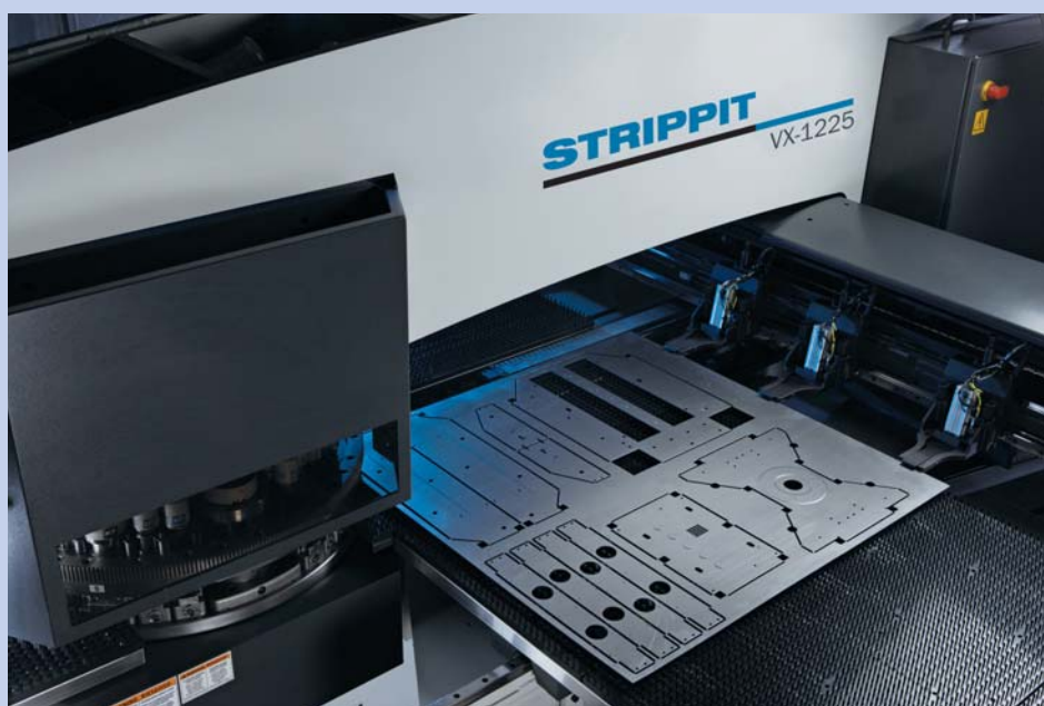
De nieuwe Strippit VX ponsmachine haalt een slagfrequentie van 530 per minuut bij 25 mm steek
