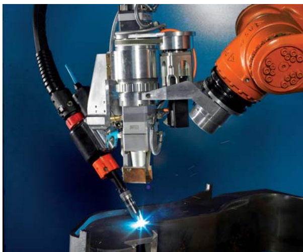
Figuur 11. Laser-hybridelaskop voor een laservermogen tot 20 kW (foto: Cloos)
