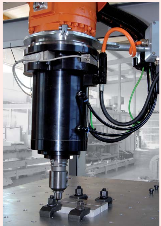
Figuur 12: CyTec toonde in Essen het driedimensionale wrijvingsroerlassen (foto: Cytec)
