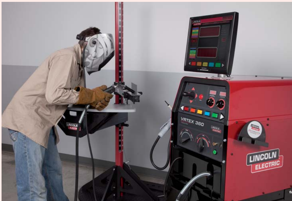
Figuur 13. Virtueel lassen bij Lincoln Electric benadert bijna de werkelijkheid (foto: Lincoln Electric)
