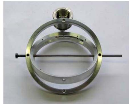
Enkele nauwkeurige onderdelen voor een tiltswing lens zoals die op de Maxxturn 65-SMY in een enkele opspanning compleet worden bewerkt (foto: Jan Oonk)
