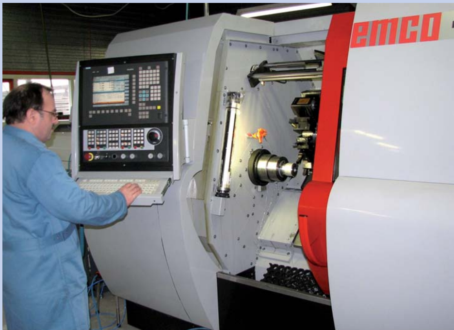
De Maxxturn 65-SMY bij Cambo. Dankzij een ruime opening is de werkruimte optimaal toegankelijk en het draaiproces is via een groot venster goed te volgen. Met name bij prototypes en enkelstuks is dat een voordeel (foto: Jan Oonk)
