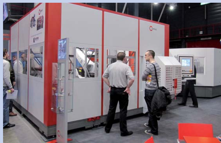
Hermle pakte in Utrecht uit met een grote robotcel: een vijfassige C 30 U gekoppeld aan een RS2 robotsysteem. Na de beurs ging deze flexibele cel naar Kusters Metaalbewerking
