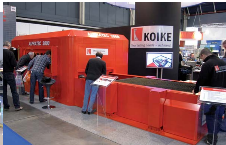
Koike toonde de volledig omkapselde Alphatec 2000 plasmasnijmachine, die stiller, schoner en veiliger snijdt dan conventionele plasmasnijmachines
