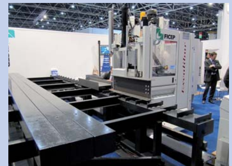
Oude Reimer toonde een nieuwe CNC-boormachine van Ficep: de Excalibur. Dit is een horizontale machine voor de staalbouw. Kenmerkend is de bewegende boorkolom. Dit resulteert in een compacte bouwwijze
