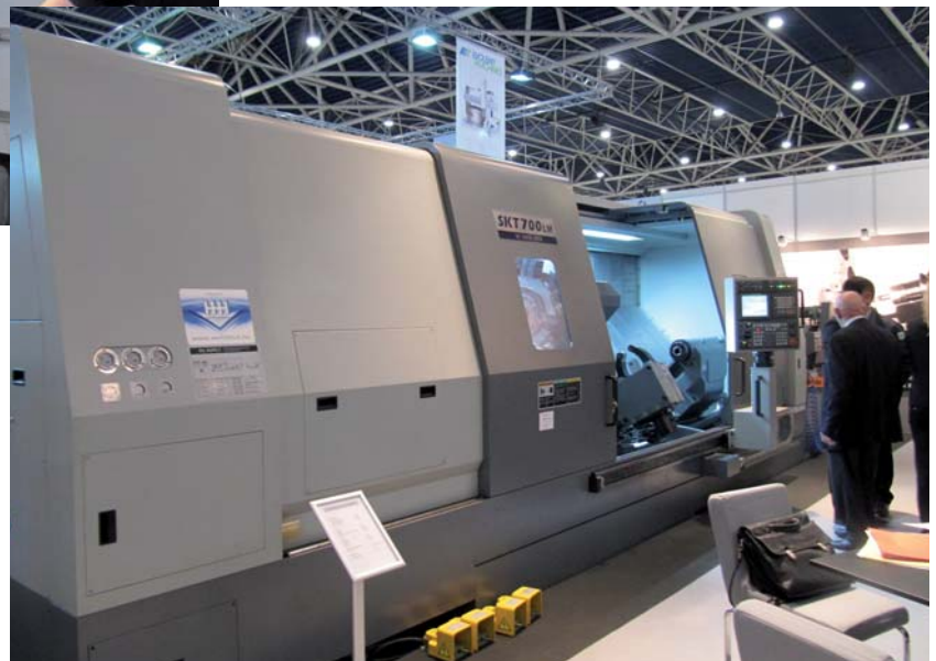
Een grote draaimachine op de stand van Dymato: de SKT 700 LM van Hyundai Kia. Een machine met een draailengte van 3250 mm en een maximale draaidiameter van 920 mm. Een van de grotere machines op de beurs
