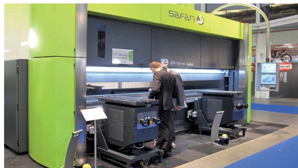
Safan toonde in Utrecht de grootste E-Brake ooit, de Dual Drive 300T 4100 servo-elektronische kantpers, waarbij de tot nu toe gebruikte enkelvoudige katroltechniek is uitgebreid naar een dubbel uitgevoerde katroltechniek
