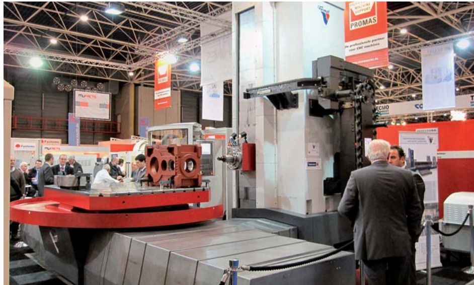
Een van de grootste machines was ongetwijfeld deze Fermat WFT 13 CNC kruisbed koterbank met een Heidenhain iTNC530 besturing en een werkbereik van 3.500 mm (X), 2.500 mm (Y) en 1.700 mm (Z)
