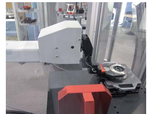
Erowa liet in Utrecht een nieuwe Robot Dynamic zien; een modulaire beladingsunit die 'om de hoek' kan beladen en tot acht machines kan voorzien van werkstukken
