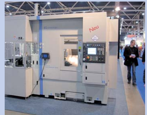
Hardinge toonde onder meer deze nieuwe CNC-draaibank GS 51A met volautomatische belading en in 'performance plus' uitvoering. Dat betekent een nog nauwkeurigere, snellere en stabielere bewerking van producten
