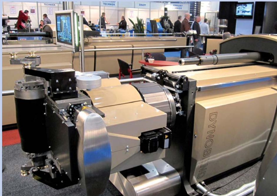
Een echte beursprimeur toonde Dynobend met de combibuigmachine Elite. Het vlak waarin gebogen wordt, is vrij te kiezen. Hierdoor kunnen er complexere producten gebogen worden
