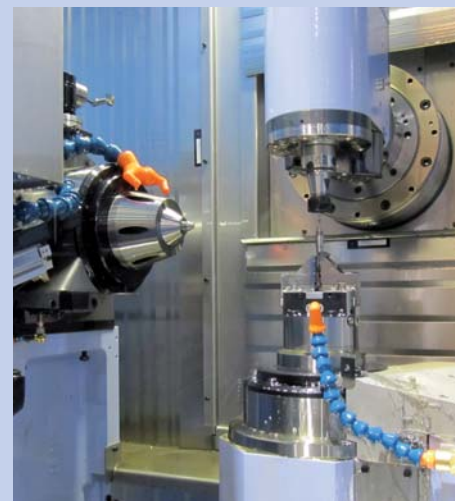
Heel mooie machinebouw op de stand van Esmeijer: de Bumotec S-191 Linear. Een bijzondere meerassige machine voor het compleetbewerken vanaf staf van precisiewerkstukken
