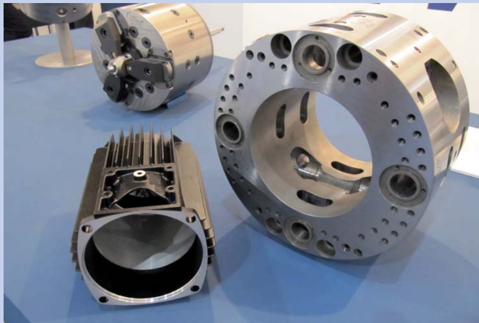
Voor het bewerken van pomphuisen heeft Staalmach voor Grundfos een bijzondere klauwplaat ontwikkeld die in Utrecht getoond werd. Engineering en productie van deze bijzondere opspanmiddelen verzorgt Staalmach zelf
