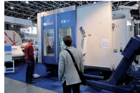
Een grote machine op de stand van Tecmo was het vijfassige bewerkingscentrum RX10 van Reiden Techniek. Een machine met de zogeheten DDT-aandrijftechnologie (Double Drive Technology)
