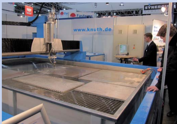
Voor maar 106.900 euro kon een bezoeker van de Techni-Show 2010 de waterstraal-snijmachine Hydro-Jet 3020 van Knuth 'meenemen'. Een 4000 bar machine met een snijtafel van 3 m x 2 m
