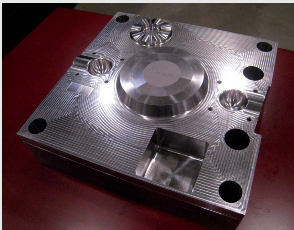
Proefwerkstuk van Makino om de nauwkeurigheid van een vijfassige machine te beoordelen in vergelijking met een drieassige machine. Heel bijzonder is de ring in het midden: de binnenste ring is gemaakt door drieassig verspanen, de zes vlakken van de middenschil door 2+3-assig bewerken en de buitenschil door vijfassig simultaan (foto: Reinold Tomberg)
