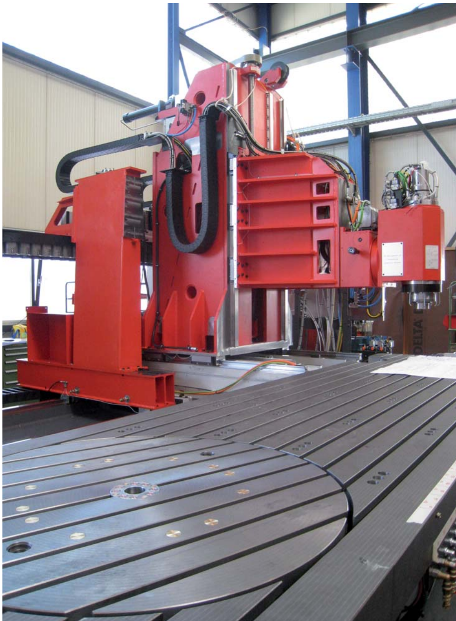
Een grote rondtafel, de vijfde as, in het bed van een Matec langbedmachine. Dit is ook een machine met een behoorlijke Y-as (foto: Reinold Tomberg)
